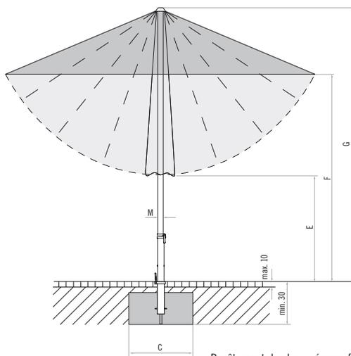
Revêtement de chaussée non fixé max. 10 cm, épaisseur du béton min. 30 cm (tenir compte de la profondeur hors gel), écoulement de l'eau
