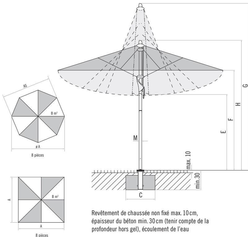
Revêtement de chaussée non fixé max. 10 cm, épaisseur du béton min. 30 cm (tenir compte de la profondeur hors gel), écoulement de l'eau
