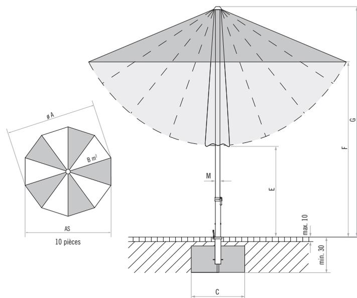
Revêtement de chaussée non fixé max. 10 cm, épaisseur du béton min. 30 cm (tenir compte de la profondeur hors gel), écoulement de l'eau
